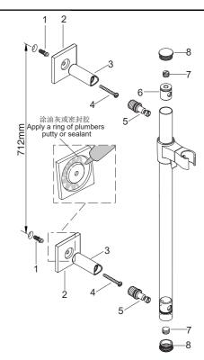
根据安装尺寸和胀塞(1)直径在墙面上适当的高度打两个孔,两孔之间距离是712mm。将胀塞分别塞入孔中。
